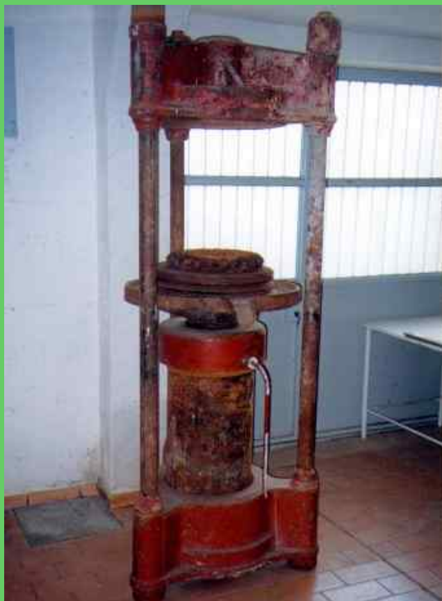
Foto n. 2 vecchia macchina per la spremitura dell’olio (si ringrazia Nicola Pepa e l’Associazione “Amici del Museo delle Arti e Tradizioni Popolari di Civitanova Marche”).
